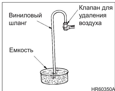
2. Снимите резиновую крышку с воздушного предохранительного клапана на усилителе муфты сцепления, вставьте один конец прозрачного винилового шланга, а другой поместите в емкость с тормозной жидкостью.
