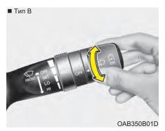
Для использования стеклоомывателя ветрового стекла переместите рычаг управления стеклоомывателем в положение ON. Омывающая жидкость будет распыляться на ветровое стекло.
