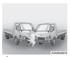
При наклонном или угловом ударе пассажиры могут переместиться в направлении, в котором подушки безопасности не смогут обеспечить дополнительную защиту, поэтому датчики не должны раскрывать их.
