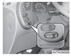
Если температура окружающего воздуха очень низка или при необходимости прогреть двигатель, нажмите «UP»(ВЫШЕ) на переключателе управления двигателем для повышения оборотов двигателя. Нажатие «DOWN»(НИЖЕ) понижает обороты двигателя.
