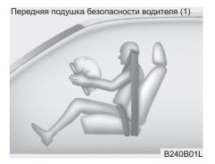
Модули подушек безопасности расположены в центре рулевого колеса и в перчаточном ящике. Если блок SRSCM регистрирует фронтальный удар достаточной силы, он автоматически раскрывает передние подушки безопасности.
