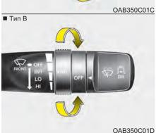
Регулируемый прерывистый режим работы стеклоочистителя (при наличии) Чтобы использовать прерывистый режим работы стеклоочистителя, установите переключатель
