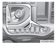
Прикуриватель работает, если ключ зажигания находится в положении «АСС» (Вспомогательное положение) или «ОN» (Включено).
