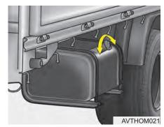
Топливный бак расположен с левой стороны рамы шасси.
