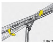
2.Слегка приподнимите щетку очистителя и вытащите ее резким усилием.
