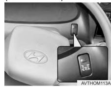
Это выключатель вала отбора мощности (ВОМ), который позволяет передавать мощность коробки передач на специальных автомобилях.
