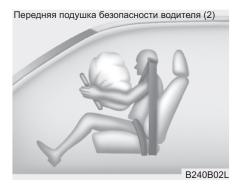
При раскрытии разрывные швы в крышках подушек безопасности расходятся под давлением раскрытия подушек. Затем крышки открываются, что позволяет подушкам безопасности полностью раскрыться.
