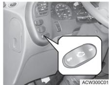
Для того чтобы облегчить пуск двигателя в холодную погоду, нажмите переключатель холодного пуска двигателя, установив в положение «ON» (Включено). После этого загорится световой сигнал (то)режима предпускового Если прогрева. световой сигнал режима предпускового прогрева не горит, запустите двигатель. После успешного пуска двигателя, нажмите этот переключатель еще раз, чтобы установить его в положение «OFF» (Выключено).
