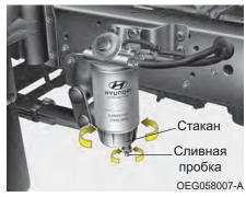
Замена (D4DD, D4GA Модель) Фильтрующий элемент топливного фильтра не может использоваться повторно.
