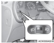
Чтобы отрегулировать пучок света фар в соответствии с количеством пассажиров и загрузкой багажного отделения, необходимо повернуть переключатель регулировки наклона пучка.
