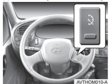
Это выключатель вала отбора мощности (ВОМ) двигателя, который позволяет передавать мощность двигателя на специальных автомобилях.
