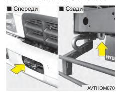
Если возможности услугами воспользоваться буксировке в экстренной ситуации, можно временно буксировать ваш автомобиль при помощи троса, цепи или ремня, прикрепленного к буксирным крюкам под передней/задней частью вашего автомобиля. Во избежание повреждения вашего автомобиля будьте предельно осторожны при попытке выполнить буксировку по грунтовой дороге.
