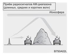
Сигналы АМ-диапазона могут приниматься на большем удалении от радиостанции, чем сигналы FМ-диапазона. Причина этого - в более низкой частоте радиоволн АМ-диапазона. Эти радиосигналы с большой длиной волны и низкой частотой распространяются не по прямой линии в атмосфере, а могут огибать земную поверхность. Кроме того, они огибают препятствующие их распространению объекты, что обеспечивает лучший приём сигнала.
