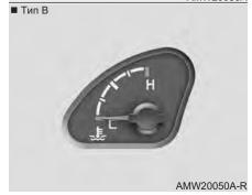
Индикатор температуры охлаждающей жидкости двигателя
