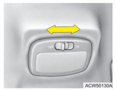
кабины Внутреннее освещение 3-позиционным снабжено переключателем. Эти три позиции следующие:
