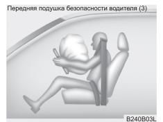
Полностью заполненная подушка безопасности вместе с правильно пристегнутым ремнем безопасности замедляют перемещение водителя вперед и снижают риск травмирования головы и грудной клетки.
