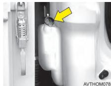
Из бачка омывателя жидкость подается в систему омывателя ветрового стекла.
