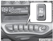
Для vскорения транспортного средства на подъеме или ровной дороге нажмите выключатель удвоенной мощности и педаль акселератора. При нажатии выключателя удвоенной мощности загорается индикатор (
