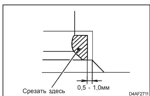
13. Проверьте, есть ли достаточный натяг между седлом клапана и поверхностью головки блока цилиндров.
