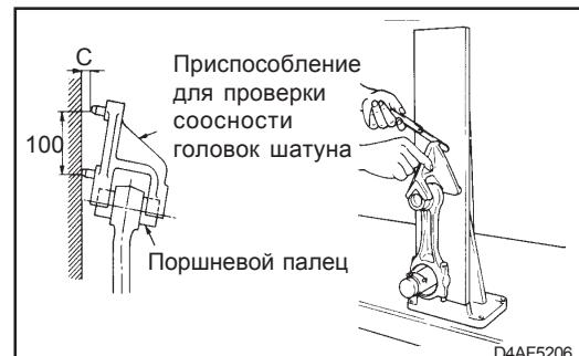
2) Измерение скручивания
