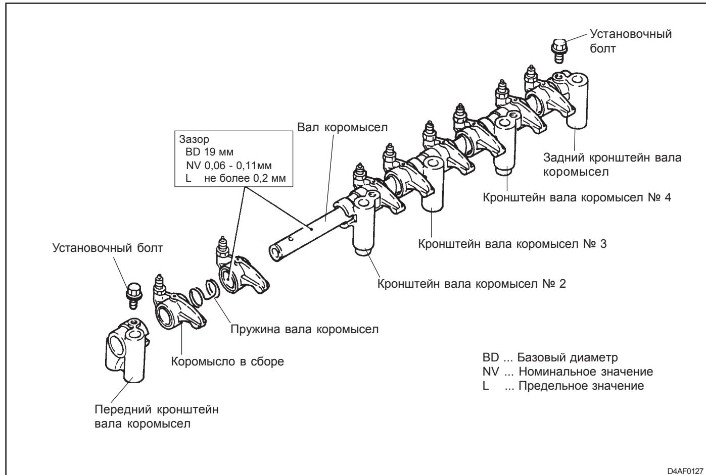
Измерьте внутренний диаметр коромысла и внешний диаметра вала коромысел, рассчитайте значение зазора. Если оно превышает предельное допустимое значение, замените втулку коромысла. Для ее замены используйте специальное приспособление - Съемник втулки коромысла.
