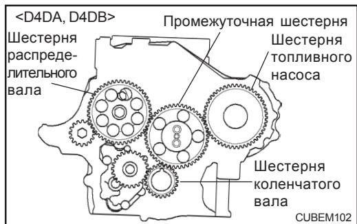
5. Проверьте зазор между шестернями.
