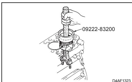
8. Использование обжимной оправки для поршней.
