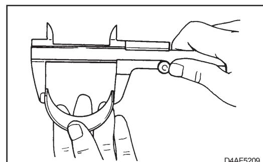
9. Зазор между шатунным подшипником и коленчатым валом
