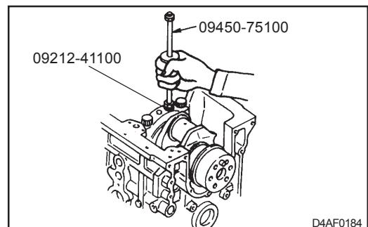
8. Снятие шестерни коленчатого вала
