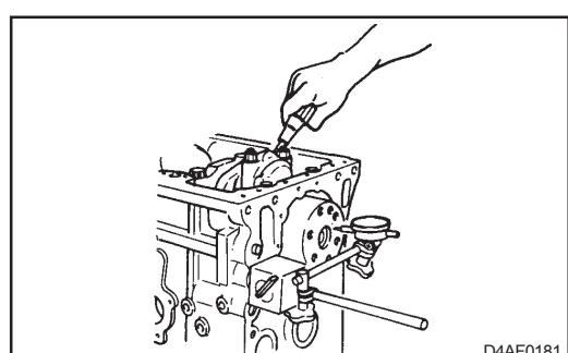
6. Для снятия крышек переднего и заднего коренных подшипников воспользуйтесь специальными инструментами (09212-41000 и 09450-75100).
