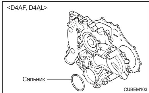
6. Нанесите литиевую консистентную смазку на рабочие поверхности сальника.
