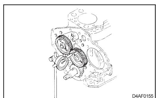
5. Снятие шестерни распределительного вала
