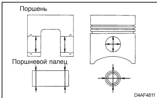
5. Зазор между поршневым пальцем и втулкой верхней головки шатуна
