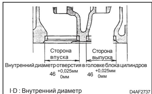
14. Установите седло клапана с помощью специальных инструментов - выколотки и оправки.
