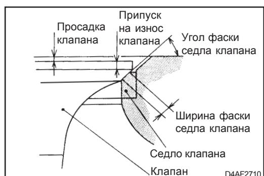
12. Запрессовка седла клапана производится в холодном состоянии. Ниже описана процедура замены.
