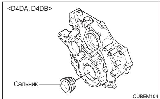
7. Сборка картера распределительных шестерен
