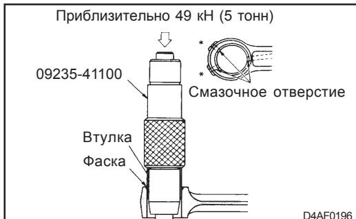
2. При установке втулки следите за совмещением смазочных отверстий во втулке и в головке шатуна.
