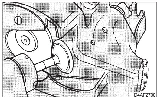
10. Для корректировки седла клапана используйте специальную фрезу или абразивную головку.
