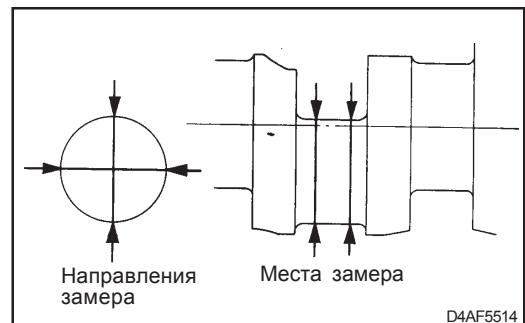
10. Зазор между коренным подшипником и коленчатым валом.
