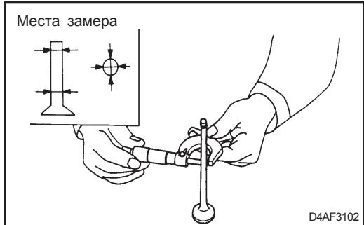
6. Замерьте внутренний диаметр направляющей втулки клапана и внешний диаметр стержня клапана, рассчитайте величину зазора. Если предельное допустимое значение превышено, замените направляющую втулку.
