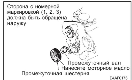
4) Проверьте зазор между шестернями.
