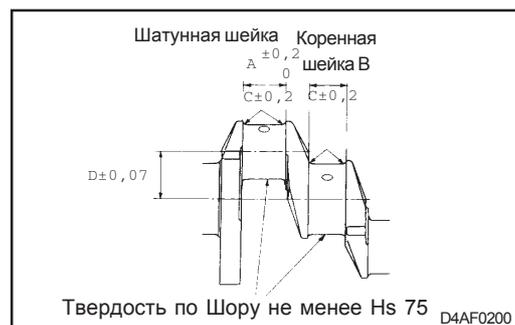
При повреждении или заклинивании коренной или шатунной шейки, перешлифуйте коленчатый вал. Процедура перешлифовки описана ниже. Замените подшипник на новый - уменьшенного ремонтного размера.
