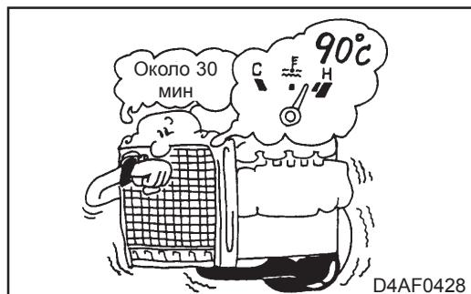
4. После слива раствора наполните систему водопроводной водой (желательно горячей) и, поддерживая температуру воды равной приблизительно 90°C, дайте двигателю поработать на холостом ходу около 10 минут. После этого слейте воду.
