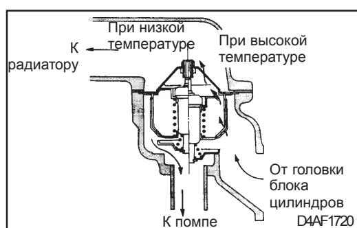
Переливной клапан обычно находится в нижнем положении. Воздух из двигателя выводится в радиатор через зазор между переливным клапаном и отверстием сапуна, что позволяет облегчить подачу хладагента.
